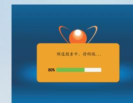
菜单“系统设置”-->“信号安装与检查”，按确定可进入菜单并检查信号强度。进入菜单的密码出厂设置为“0000”。如接收机开机未搜到节目，天线连接正常后，进入菜单“系统设置”->“自动搜索”，可重新自动搜索节目。
